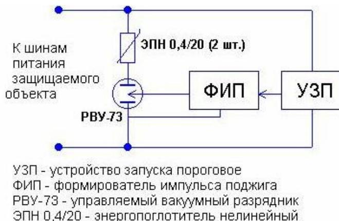
Рис. 3 – Структурная схема блока защиты от перенапряжений.
